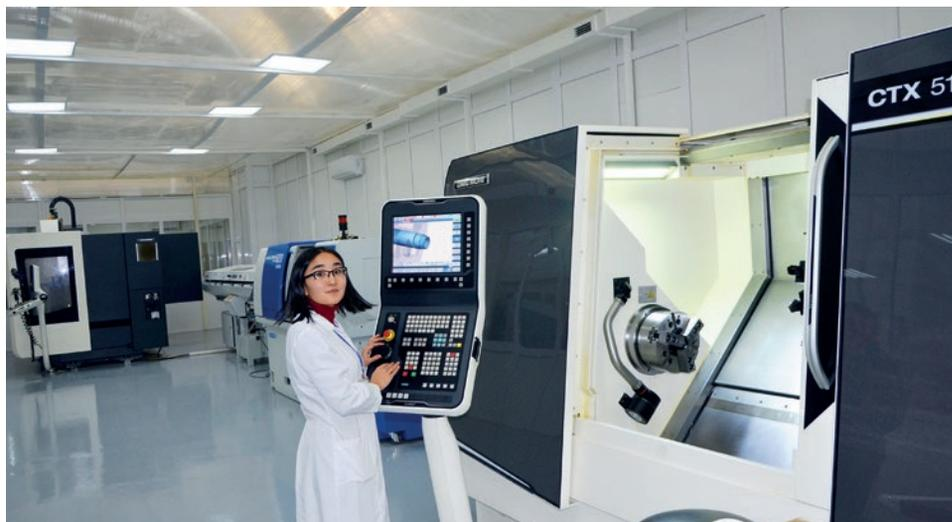
позволяет сделать для имплантатов винты и стержни любой конфигурации. Подается пруток, и в режиме автоматки станок сам изготавливает детали со сквозным отверстием. А пятиосевой фрезерный станок DMU 50 ведущего мирового производителя металлорежущих станков DMG MORI позволяет выгнать имплантаты для травматологии любой сложности.
